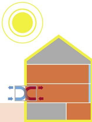
Minergie-Bauten erfüllen erhöhte Anforderungen an die Energieeffizienz. Diese wird durch eine verbesserte Wärmedämmung, ein Lüftungssystem mit Wärmerückgewinnung und die Nutzung erneuerbarer Energien erreicht. Neubauten und Sanierungen nach Minergie-A und Minergie-P werden gefördert, wenn
