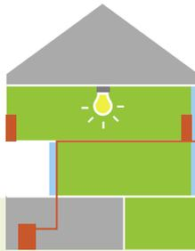
Bei der Kraft-Wärme-Kopplung (KWK) werden Strom und die dabei entstehende Wärme gleichermassen genutzt. Dies im Gegensatz zu thermischen Grosskraftwerken zur Stromproduktion, bei denen die Wärme ungenutzt in die Umwelt abgegeben wird. Eine KWK ist vor allem dann wirtschaftlich, wenn ganzjährig ein Wärmebedarf vorhanden ist. Dies ist beispielsweise beim Warmwasserbedarf eines Hotels oder einer Wäscherei der Fall.
